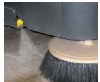
DUSTGUARD™ PORMÉG-KÖTŐ Megköti a felszálló port az oldalkeféknél
